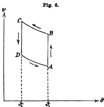
Wir wollen nun einen Kreisprocess verfolgen, der durch die Linie  $ABCD A$  dargestellt ist. Für die Linie  $AB$  soll  $\vartheta$  gleich der Constanten  $\vartheta_1$ , für  $CD$   $\vartheta = \vartheta_2$  sein, während die Linien  $BC$  und  $DA$  die Eigenschaft haben sollen, dass bei den
